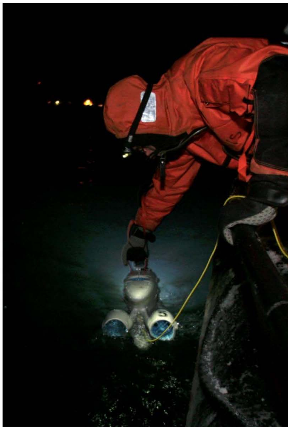
NY TEKNOLOGI: Blir testet ut for å studere livet i iskaldt hav i mørketiden. Denne roboten Blueey, kan opererer ned til 10 meters dyp og registrere selv ørsmå organismer. ALLE FOTO: OLE MAGNUS RAPP
