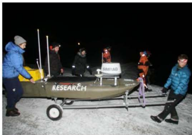
UNIK: Denne farkosten er unik, og bærer en rekke ulike sensorer som registrerer alt fra små plankton i havet, til fisk, temperatur, saltholdighet, kartlegge havbunn og mye annet. NTNU og UiT har sammen med forskere på Unis utviklet prototypen.
